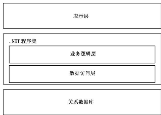
图 2 系统的 C/S 三层体系结构
