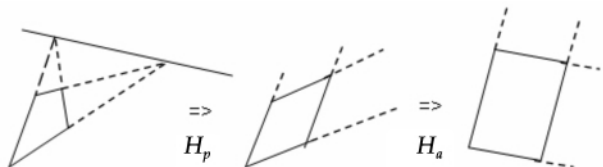
图6 射影变换和仿射变换示意图
