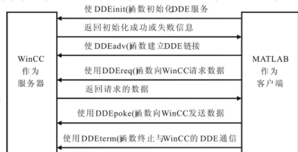
图2 MATLAB 与 WinCC 的 DDE 通信链接示意图
