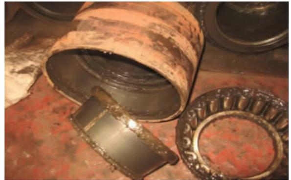
图 3 货车内圈故障轴承
