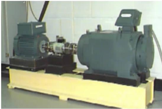
图 1 滚动轴承故障模拟试验台
