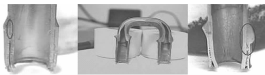
图 7 焊缝缺陷分析图
