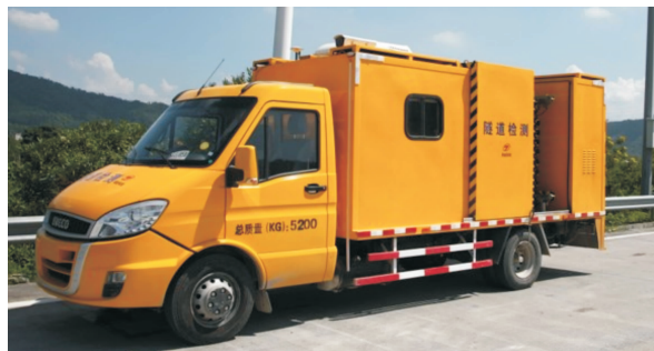
图 5 上海同岩公路隧道检测车
