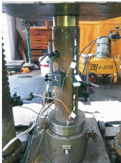
图 3 试验加载装置
