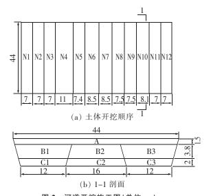
图 2 河道开挖施工图(单位:m)
