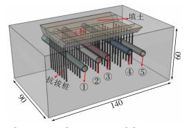
注:①-1 号线左线;②-1 号线出段线;③ $\oplus$ -4 号线出、入段线; ⑤-1 号线右线
