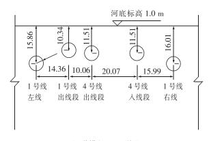
图 1 河道横剖面图(单位:m) Fig.1 Cross-sectional drawing (Unit: m)
