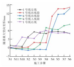
图 7 方案一各条隧道最大竖向位移变化 Fig.7 The max vertical displacement of the tunnels under NO.1 scheme
