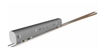
图 4 车辆—道岔耦合动力学模型 Fig.4 Vehicle-turnout coupling dynamic model
