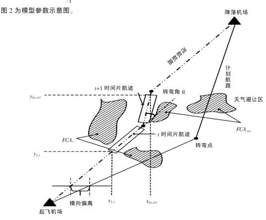
图 2 模型参数示意图 Fig.2 Model parameter diagram
