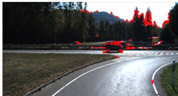
图 2 Fast 算法提取结果 Fig.2 Extraction results of Fast algorithm
