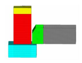
图 1 车墩碰撞模型 Fig.1 Vehicle-pier collision model
