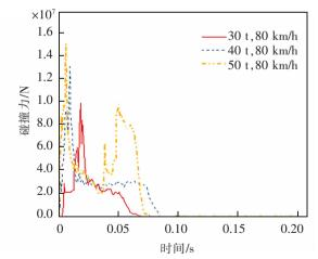
图 6 不同载重车辆碰撞力时程曲线
