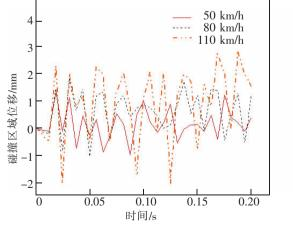
图 3 碰撞区域位移-时程曲线
