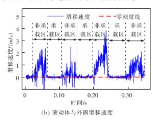
图 4 在减速度为 180 rad/s<sup>2</sup> 下滚动体与内外圈的滑移速度 Fig.4 Sliding speed between rolling elements and raceways at a deceleration of 180 rad/s<sup>2</sup>
