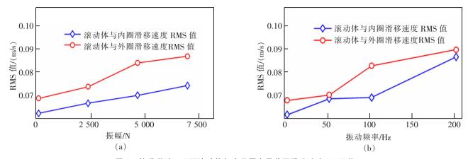
图 8 轨道激励工况下滚动体与内外圈在承载区滑移速度 RMS 值
