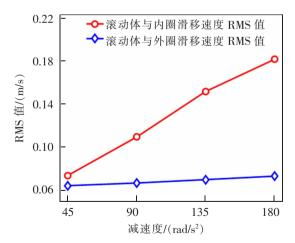
图 5 减速度工况下滚动体与内外圈在承载区滑移速度 RMS 值
