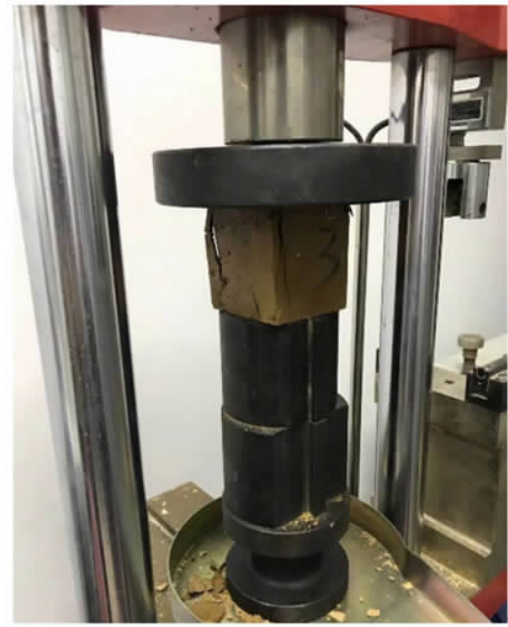
图4 水泥土的塑性破坏
