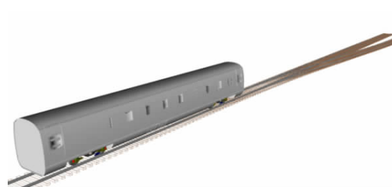
图3 车辆-道岔耦合动力学模型
