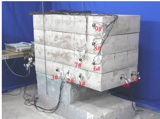
图 2 试验模型测点
