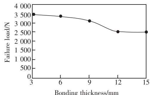
图9 不同黏结厚度时的破坏荷载
