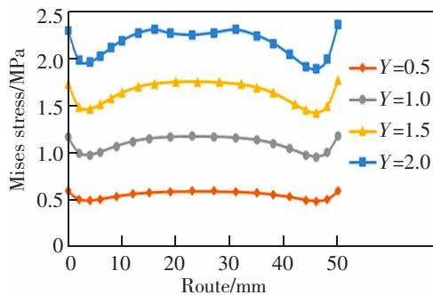
图 14 管片错台时黏结面应力路径
