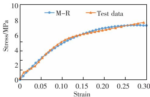
图 2 环氧树脂材料单轴拉伸试验参数拟合对比
