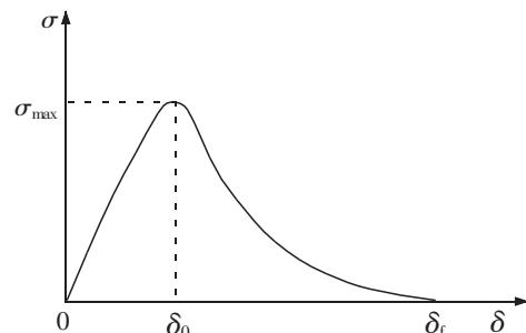
图 3 内聚力模型应力-位移关系
