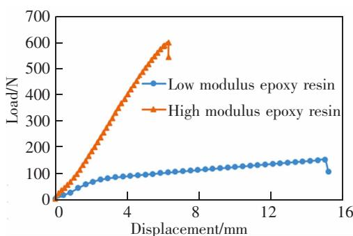
图11 不同材料环氧树脂单轴拉伸试验曲线
