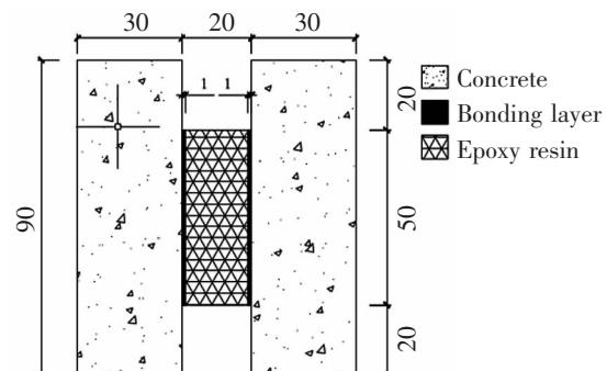
图 4 有限元计算模型尺寸(单位:mm)
