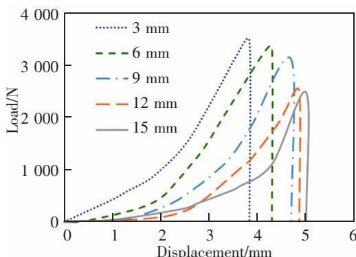
图7 不同黏结厚度试件的荷载-位移曲线
