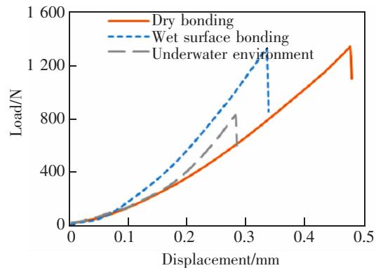
图6 不同潮湿程度条件下8字形试件黏结拉伸试验曲线
