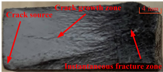
(d) Macro fracture of 8 mm thickness sample
