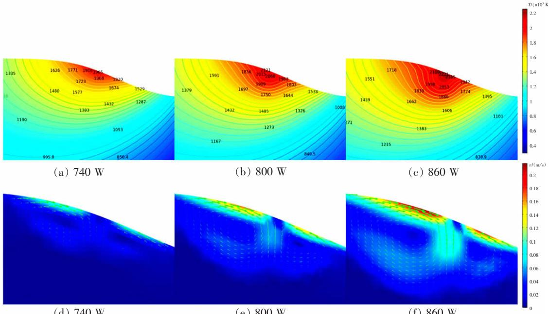
图 6 不同功率下熔池温度场与速度场
