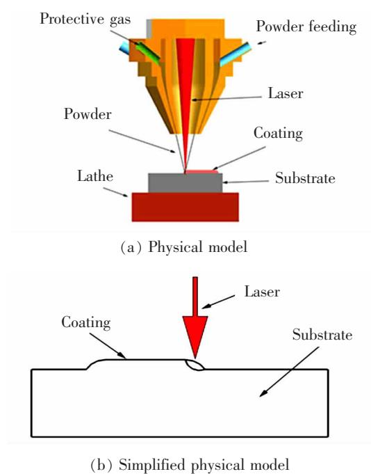
图1 激光熔覆物理模型
