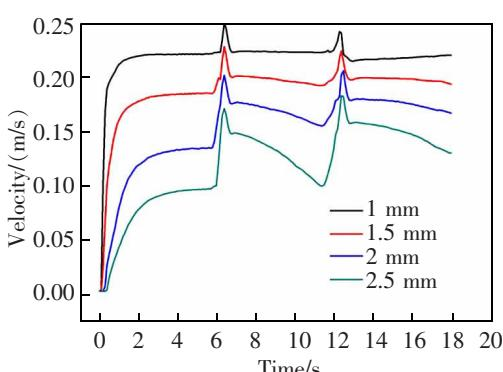
图 9 不同光斑半径下熔池流速峰值
