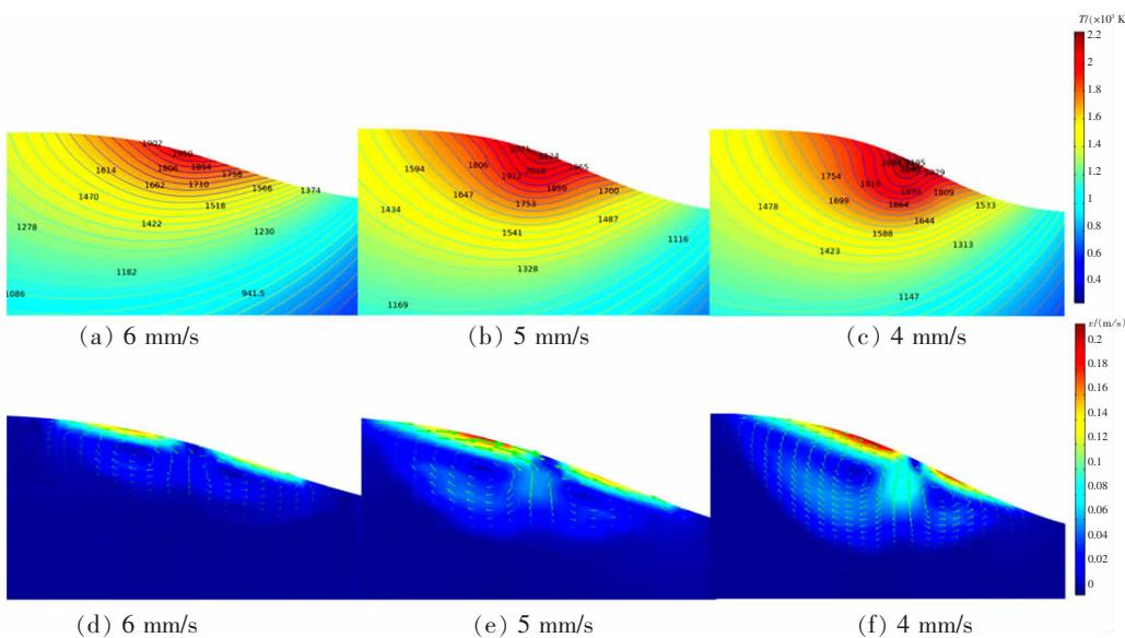
图 10 不同扫描速度下熔池温度场与速度场
