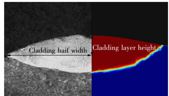
图 4 熔覆层的横截面尺寸实验与模拟结果对比示意图
