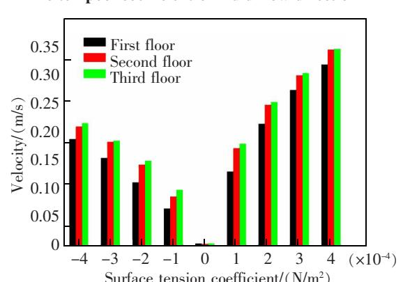
图15 不同表面张力系数下熔池流速峰值
