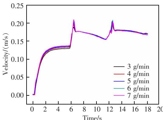
图13 不同送粉率下熔池流速峰值
