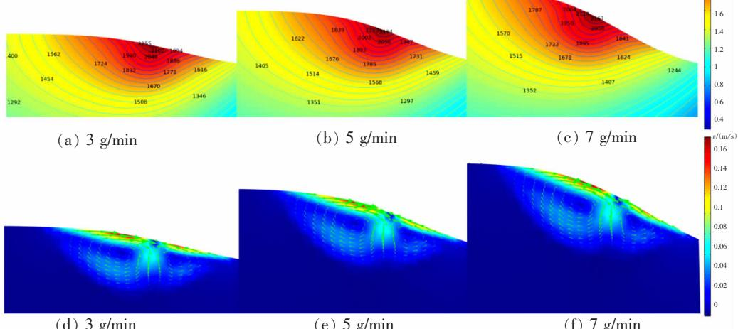
图 12 不同送粉率下熔池温度场与速度场
