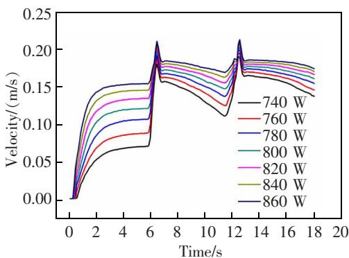
图 7 激光功率对熔体流速峰值影响
