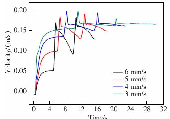
图 11 不同扫描速度下熔池流速峰值
