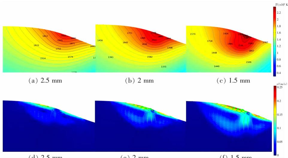
图 8 不同光斑半径下熔池温度场与速度场
