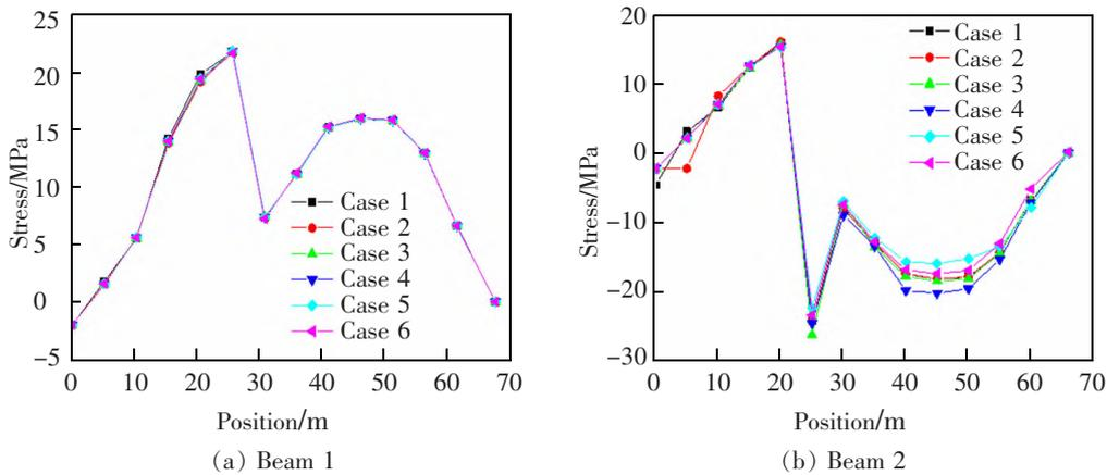
图 6 施工阶段 1 时双主梁应力变化
