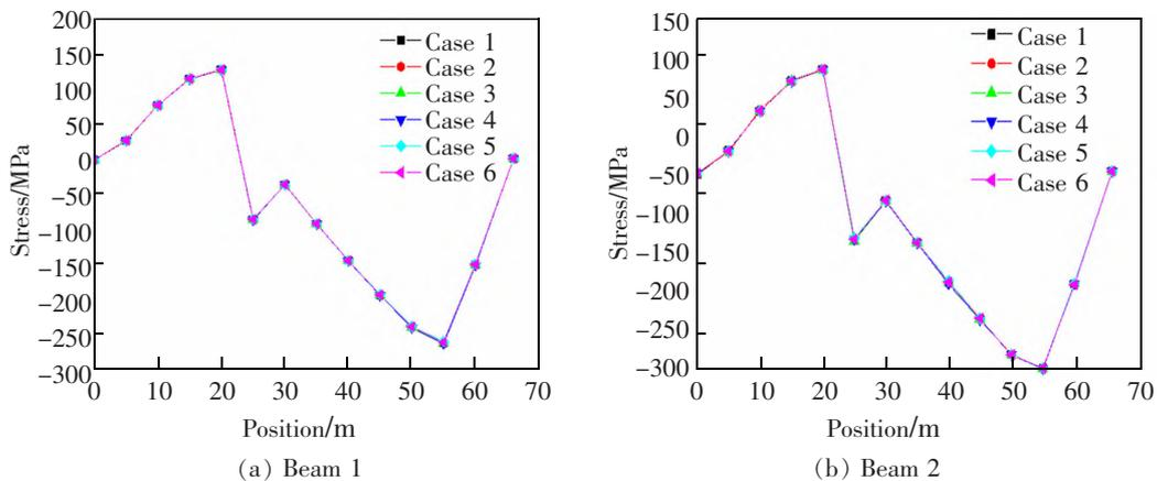
图 7 施工阶段 2 时双主梁应力变化
