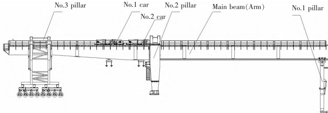
图1 JQ900A型架桥机外形结构总图
