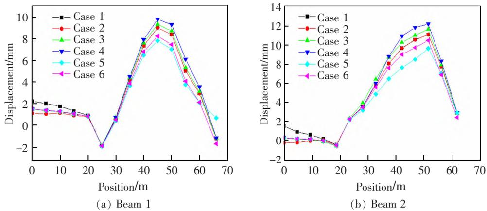
图 5 施工阶段 2 时双主梁位移变化
