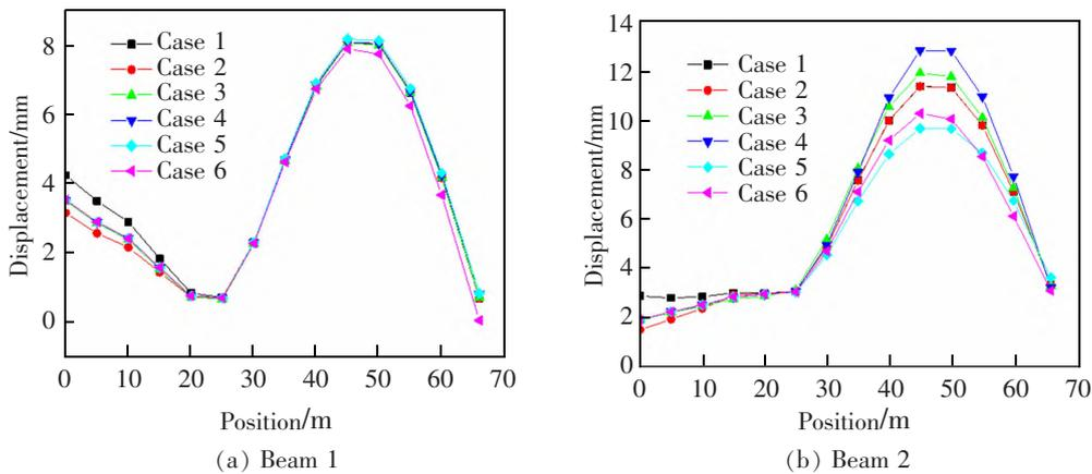
图 4 施工阶段 1 时双主梁位移变化
