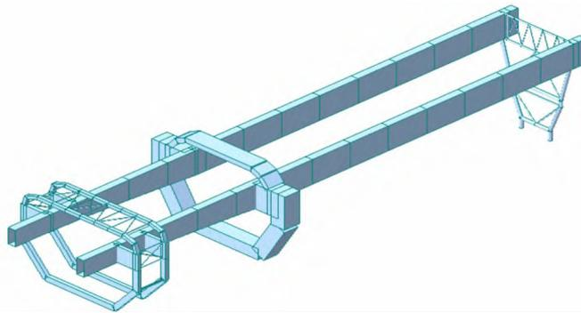
图2 JQ900A型架桥机有限元模型
