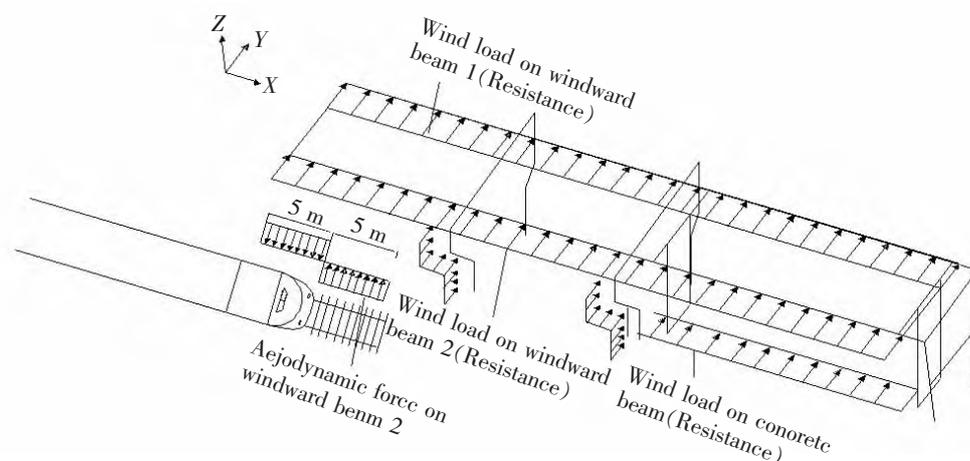
图3 JQ900A型架桥受力示意
