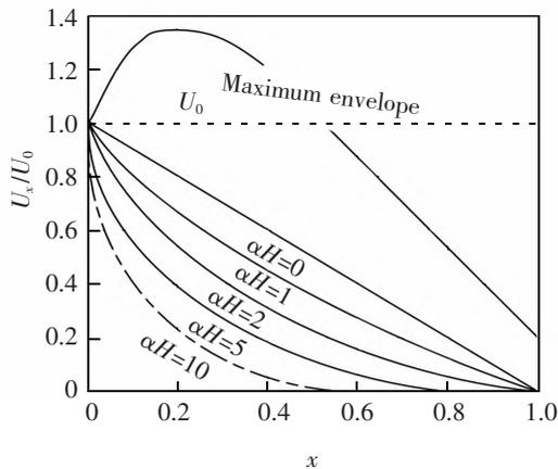
图1 电压互感器高压绕组起始电压分布特性
