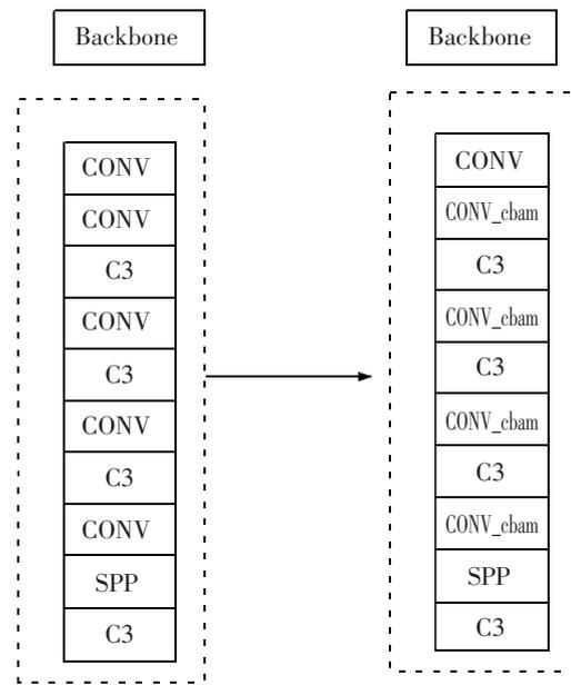
图 2 融合 CBAM 模块的 YOLOv5s 算法结构图
