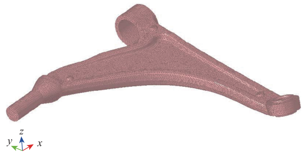
图1 下控制臂有限元网格模型 Fig. 1 Finite element mesh model of the lower control arm
