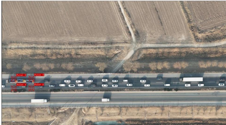
图 3 基于四个参考点的坐标标定界面
