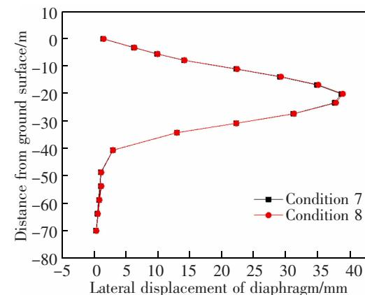
图 6 桥基施工前后地连墙侧移图
