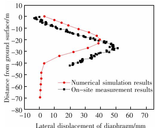
图 11 地连墙侧移现场实测与计算结果比图
