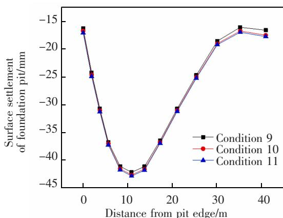
图 8 基坑拆撑回筑后基坑地表沉降
