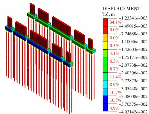
图 7 高铁桥基竖向变形云图
