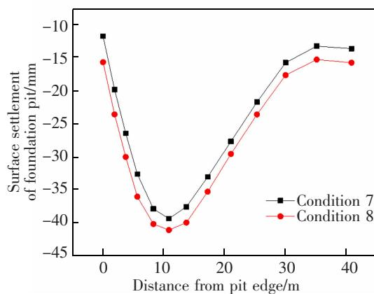
图 5 桥基施工前后基坑地表沉降图
