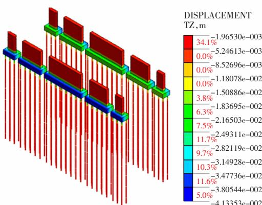
图 9 基坑拆撑回筑后高铁桥基沉降
